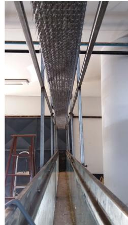
(b) Chuvímetro instalado acima do canal
