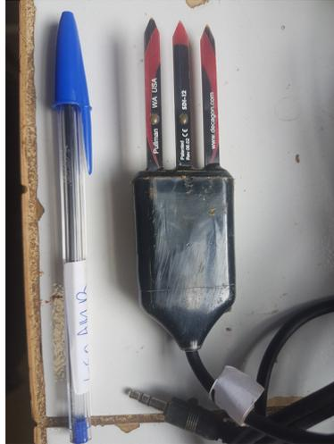
Todos os sensores utilizados para medidas de umidade foram previamente calibrados. De maneira a atender às especificidades dos dois solos estudados, os sensores de umidade foram separados de acordo com a textura dos solos que iriam compor as barreiras hidráulicas. A Figura 3.32 apresenta os dados referentes à calibração dos sensores 1 e 2 utilizados na areia de duna.
