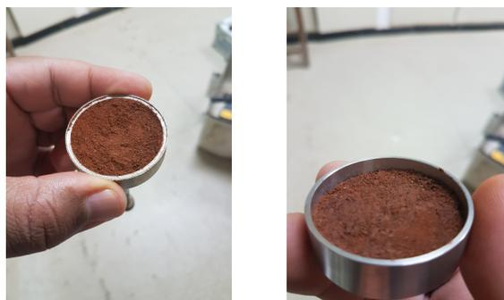
(a) Amostra de solo sendo moldada
