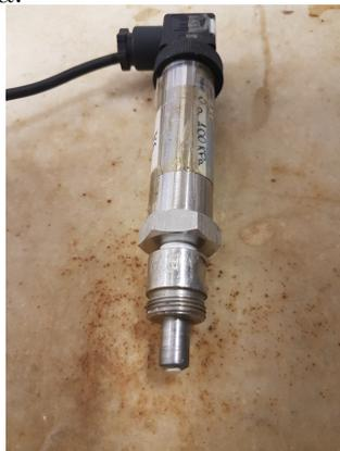
redor, o sensor de umidade mede a umidade do material poroso, e o sensor utiliza a sua curva de retenção para traduzir este valor de umidade para potencial hídrico (DEVICES, 2016). A Figura 3.24 apresenta o tensiômetro de alta capacidade utilizado nesta pesquisa.
