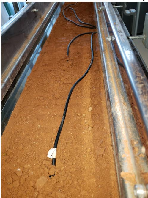
Os sucessivos avanços da camada de solo compactado podem ser vistos na Figura 3.50. Na Figura 3.50(a) é apresentada a frente de compactação na camada de profundidade de 25 cm enquanto que a Figura 3.50(b) apresenta a compactação referente à última camada.
