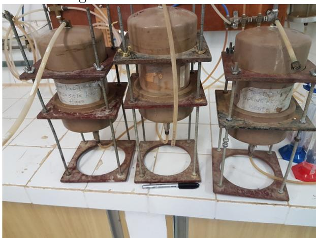
A partir dos procedimentos descritos anteriormente foram calculados os valores das condutividades hidráulicas saturadas de cada solo os quais são apresentados na sequência. Os valores de  $k_s$  foram obtidos a partir da avaliação de 3 corpos de provas compactados na energia do Proctor Normal e os resultados obtidos são apresentados na Tabela 3.11:
