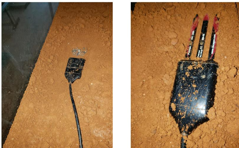
(a) Tensiômetro para altas pressões sendo inserido na camada de solo fino. (b) FDR inserido na camada de solo fino.
