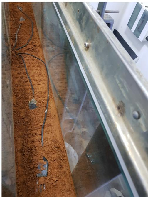
(a) Instrumentação na camada de profundidade de 35 cm.
