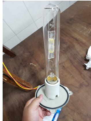
(b) Lâmpada vapor metálico em bocal cerâmico.
