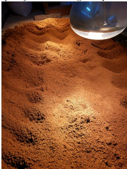
No caso da camada de areia de duna a secagem foi mais simples e o solo foi acomodado no canal usando uma placa adaptada às dimensões internas do canal como apresenta a Figura 3.44. Para atingir a densidade aparente seca de  $1,72 \text{ g/cm}^3$  foi utilizada a técnica sugerida por Diambra et al. (2010), onde é adicionada à massa seca de areia um teor muito baixo de água (1%).
