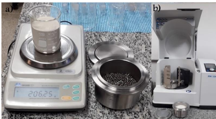
Figura 11 – Pesagem da quantidade de material (a) e moinho planetário (b)
