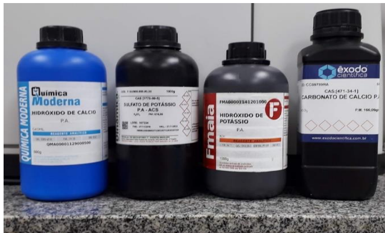
Figura 16 – Reagentes utilizados na preparação das pastas para aplicação do método R 3
