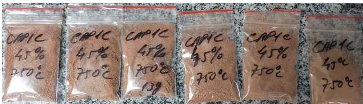
Figura 27 - Acondicionamento das massas cerâmicas
