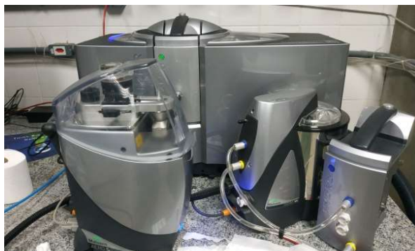
Figura 18 - Analisador de tamanho de partículas da Malvern, modelo Mastersizer 3000
