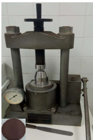
Figura 22 – Equipamento S8 Tiger(a) Prensa para produção das pastilhas.
