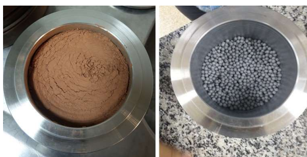
Figura 17 - Jarra de moagem com amostra (a) e esferas metálicas (b).
