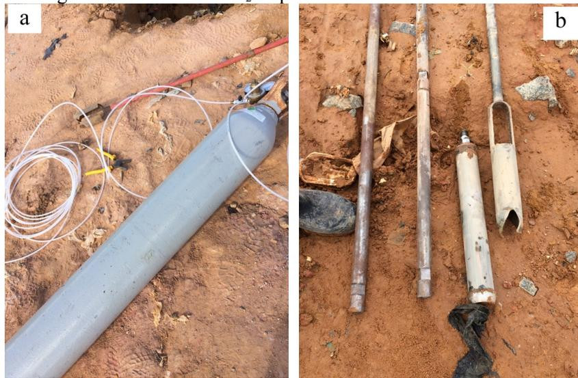
Figura 21 - Monitoramento do O<sub>2</sub> com o GEM 5000 e dreno DG 266 a no ASMC
