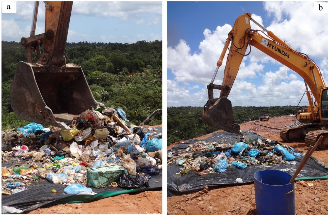
Figura 15 - Processo de separação das amostras de RN no ASMC
